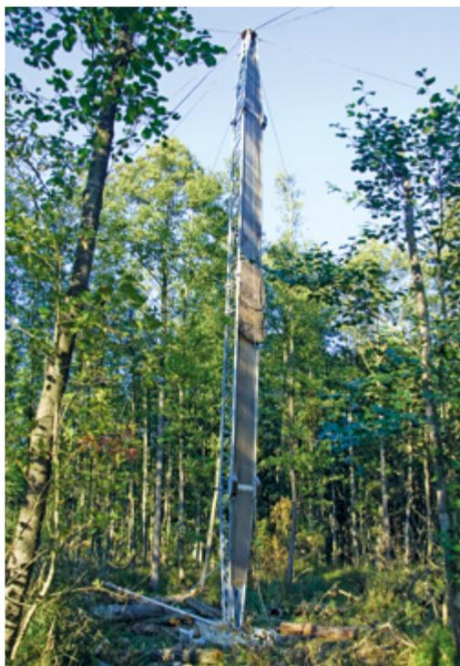
Abb. 2: 16 Meter hoher, künstlicher Endmast
